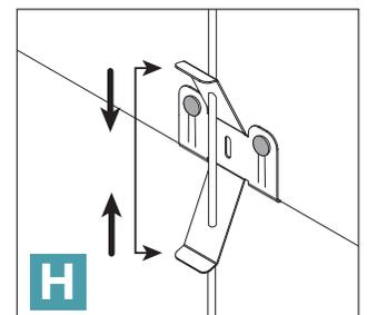
**PASO 6:** Gire todos los ganchos en la misma dirección, en paralelo a las vigas. Coloque todos los ganchos a aproximadamente la misma altura.
