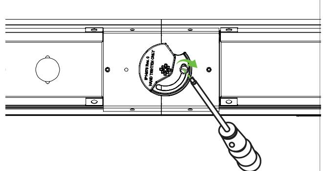
IF EXTRUSIONS DO NOT CLOSE, CHECK TO MAKE SURE THERE ARE NO WIRES PINCHED BETWEEN EXTRUSIONS TIGHTEN SCREW ON THE CIRCULAR JOINER
