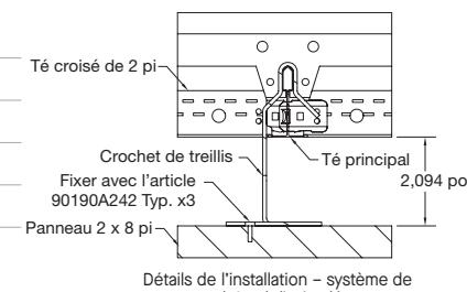
Détails de l'installation - système de plafond dissimulé
