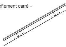
**Attache d'espacement ajustable pour suspension** – sert à espacer deux tés principaux parallèles pour des luminaires d'éclairage, des diffuseurs d'air, etc.; permet des ajustements de 1/4 po avec trois attaches différentes.
