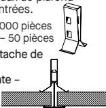
BHDC – Attache de retenue à la bordure – se fixe à la moulure d'angle pour retenir les panneaux de périphérie En acier inoxydable.
