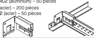
**Té croisé avec attache de raccord pour région sismique** – offre une solution testée en région sismique pour des joints de séparation dans des installations en région de catégorie D, E et F.
