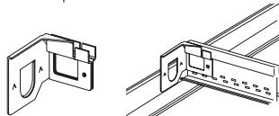
**DLCC – Attache de plafond à charge directe** – utilisée pour suspendre un système de suspension sous un treillis existant de 15/16 po, transférant ainsi le poids directement au fil de suspension; peut être utilisée pour préserver la résistance au feu d'un plafond existant ou pour supporter des accessoires lourds.
