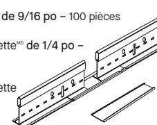
**AXSJ – Joint à glisser Axiom™** – sert à raccorder deux systèmes de plafond acoustique dans des installations en région sismique D, E et F. Peut également servir à raccorder deux systèmes de plafond différents. Trou pour fil de suspension tous les 6 po, à partir de 3 po de chaque extrémité.
