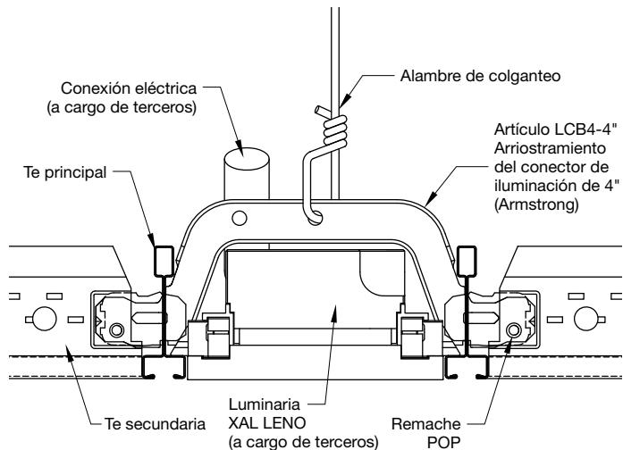
A continuación, se incluye una descripción de los componentes del sistema de plafón (cielo raso) necesario para completar uno de los diseños de plafón a eje que se describen.
