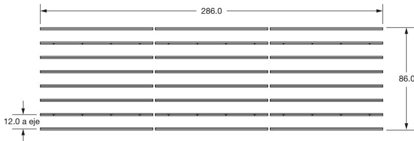
Placa ondulado con longitud de onda de 8', 94" de largo y 10" de profundidad
