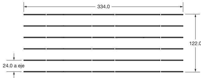
Placa convexo con longitud de onda de 8', 46" de largo y 22" de profundidad
