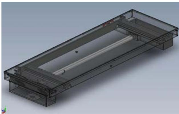
Figura 2: Imagen esquemática de VidaShield™ que muestra las lámparas UV internas y la cámara de irradiación.
