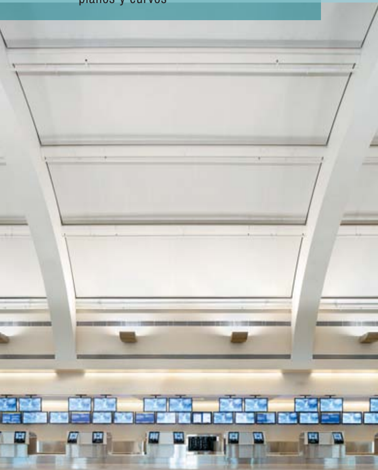
Sistema de Plafón MetalWorks™ Torsión Spring personalizado con tablonces de 30" x 82" y perforación RG 2516 en acabado Cream Weave
