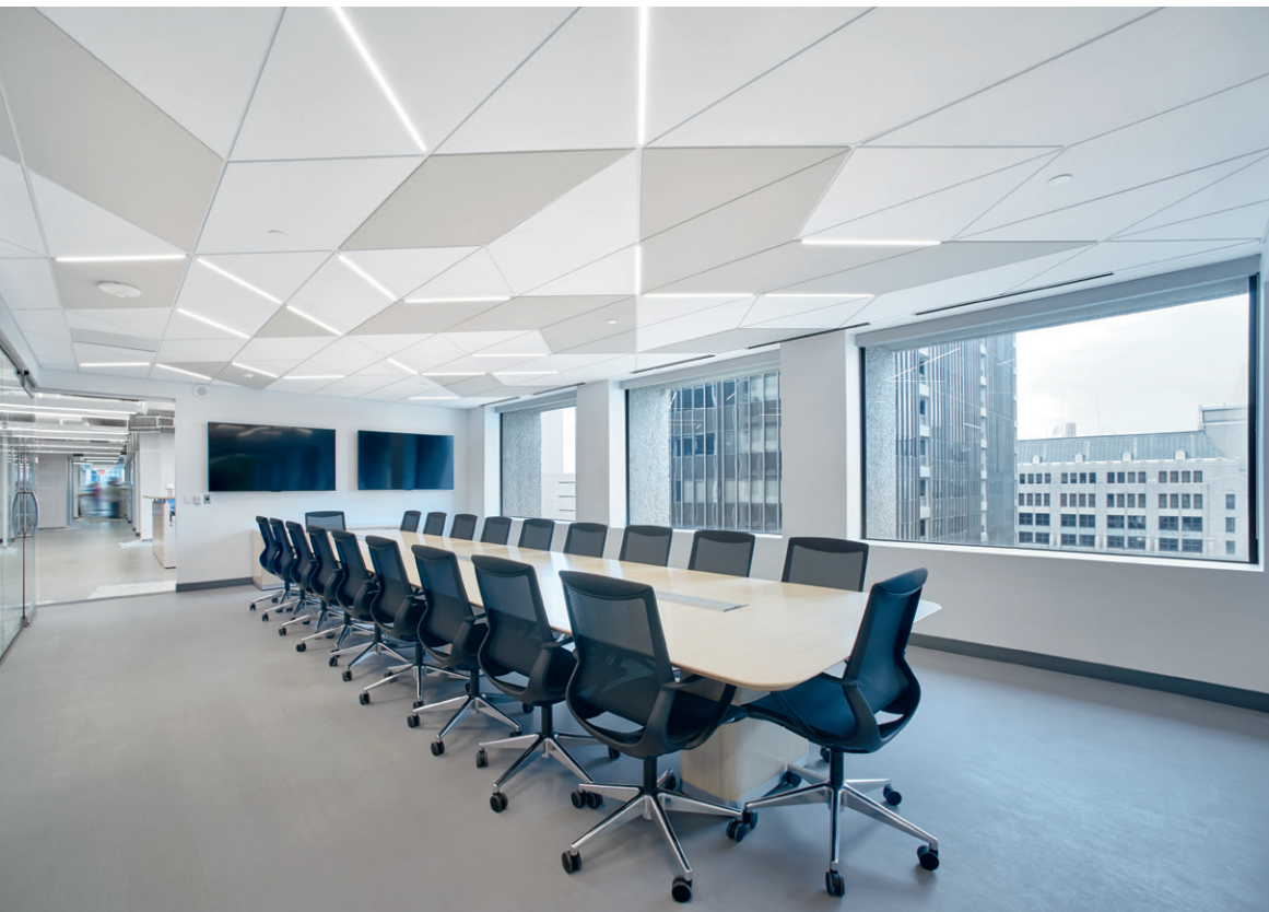
Plafones Calla Shapes con sistema de suspensión Suprafine® XM de 9/16"
