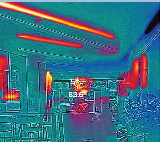
Imagen térmica que muestra las fuentes de calor internas
